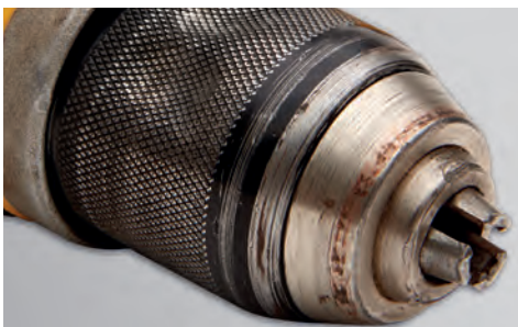
Skadet chuck - verktøyet ikke tatt vare på
