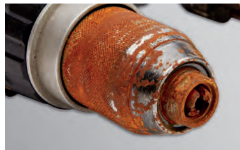
Rustet chuck - utsatt for eks. fukt
